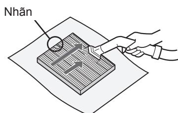
Nhẹ nhàng loại bỏ bụi bẩn ra khỏi BỘ LỌC HEPA bằng cách sử dụng một máy hút bụi hoặc dụng cụ tương tự.
