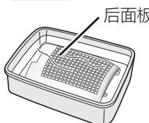
1. 在水中滴几滴中性洗涤剂，将后面板浸泡 10 分钟左右。
