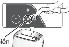
Nhé nhàng loại bỏ bụi bẩn ra khỏi cảm biến bằng cách sử dụng một máy hút bụi hoặc dụng cụ tương tự.
