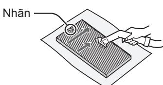
Nhé nhàng loại bỏ bụi bẩn ở bộ lọc HEPA và bộ lọc khử mùi bằng máy hút bụi hoặc bằng dụng cụ tương tự.
